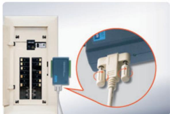
的套件，從而固定傳輸線，有效預防震動，避免脫落的發生。該特殊方案成本便宜，與用來固定印表機串列或其他傳輸線所使用的技術類似。
